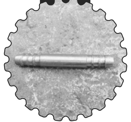
Y un acople para manguera de gas que fue cortado luego a la mitad.
