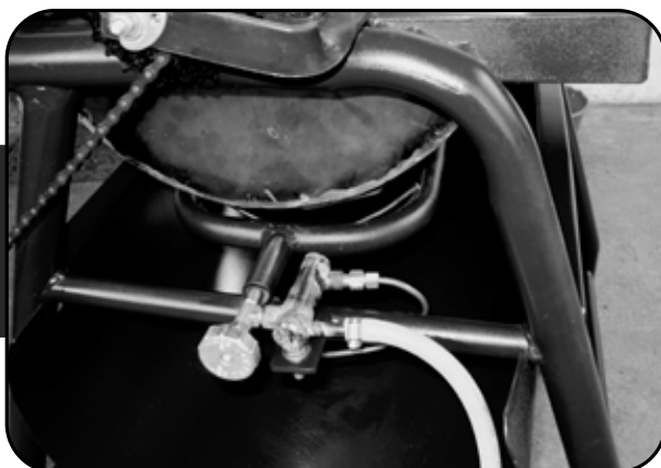
Y así se ve finalmente el quemador con su piloto automático.
